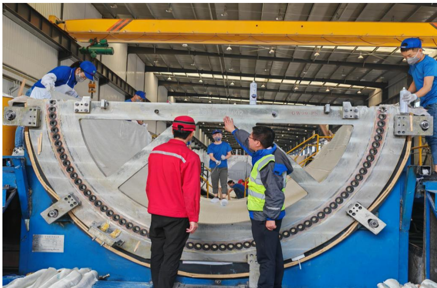
图 20 学院科技特派员许中璞现场开展拉挤版主梁错位、间隙控制技术服务
